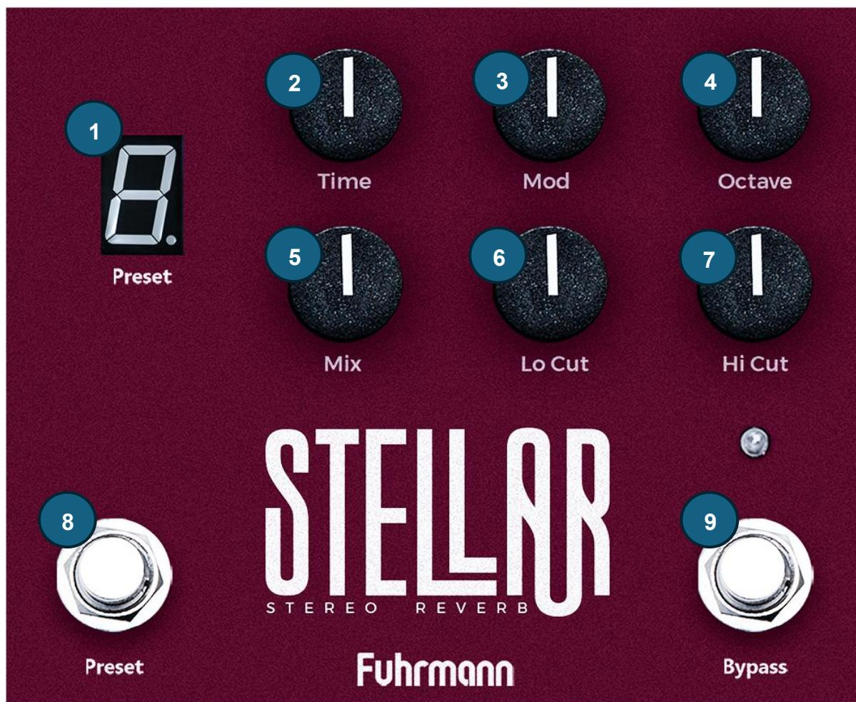
1. **Display:** Display numérico para indicar o *preset* a ser programado e/ou utilizado.
